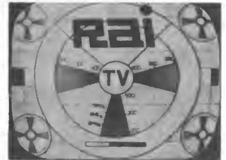
Fig. 61 — Linearità orizzontale insufficiente. Cause principali: controllo di linearità mal regolato; difetti nel circuito generatore del segnale di scansione. Vedi caso n. 23, pag. 96.
